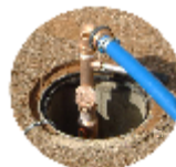
ボールバルブ付カバーバルブ50型 (砲金製) ※漏水・イタズラ防止用2重弁構造 土砂流入防止砲金蓋付 (取付口径50A)
