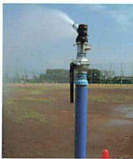
切り欠きの入ったサブノズルが、水を拡散しきれいに手前を濡らします。
