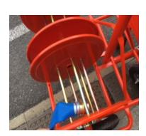
※ホースの巻き取り方ドラム内の棒の隙間(隙間が広い部分)にホースの継手のオス側を引っ掛けて巻き取ってください。ホースがヨレたりねじれないように気を付けてください。
