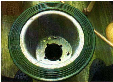
⑦ 布等できれいに内部を掃除する。 再び土砂が入り込まないように注意しながら、元のように組み立てる。
