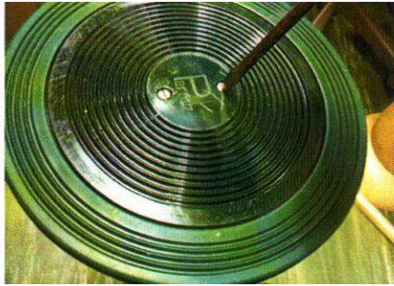
① マイナスドライバーでフタを上部のボルト2箇所を外す。
