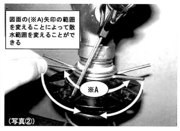
2本の角度調節リング(写真①)の、**切換レバーをはさんでいる方**の範囲を変えること(写真②)によって散水範囲を決め ることが出来ます。散水範囲の確認のやり方はスプリンクラー本体を手で左右に動かすことにより、どの範囲を散水 するかが確認できます。
