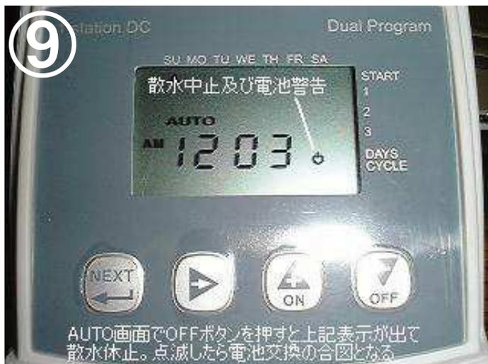
設定してある散水プログラムを一時的に休止する場合プログラムは消さずにOFFボタンを1度押すだけで休止できます。(AUTO画面にしてOFFを押す) 上記のアイコンが出たら休止中です。(復帰はON) 又、点滅したら要電池交換のサインです。
