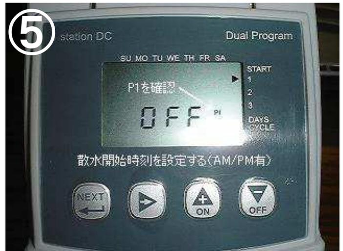
散水開始時刻の設定。ON・OFFにて散水を開始したい時刻を入力する。この時P1の表示を確認する。(P II は入力無効) AM/PMの表示に注意。 <NEXTを押す>
