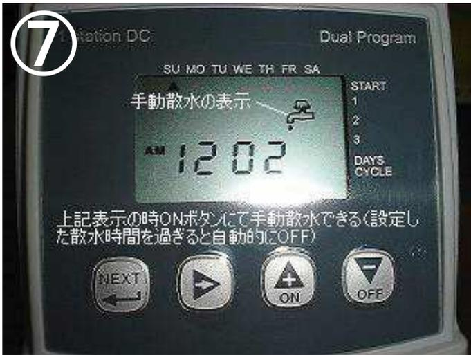
P II 入力を飛ばして何度かNEXTを押すと上記画面になる。この画面の時ONを押すと即散水を開始する。散水時間はあらかじめセットしておいた(②参照)時間を経過すると自動的に終了する。もし強制終了したい場合は、OFFを押す。(※2ステーション(PC-2)コントローラーの場合は、リレー散水しません。 <NEXTを押す>
